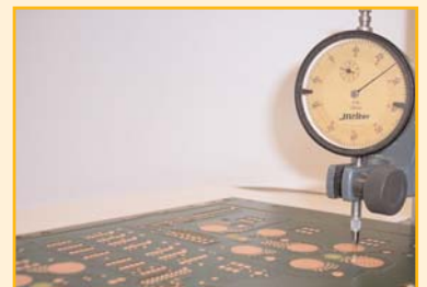
Messung der Leiterbahndicken.
