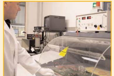
Prüfung der Durchschlagsfestigkeit am Hochspannungsgerät.
