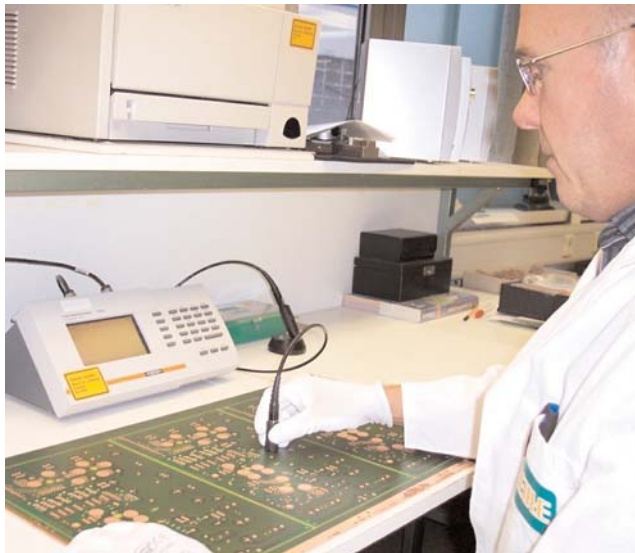
Messung der Leiterbahndicke am Fischerscope Meßgerät.
