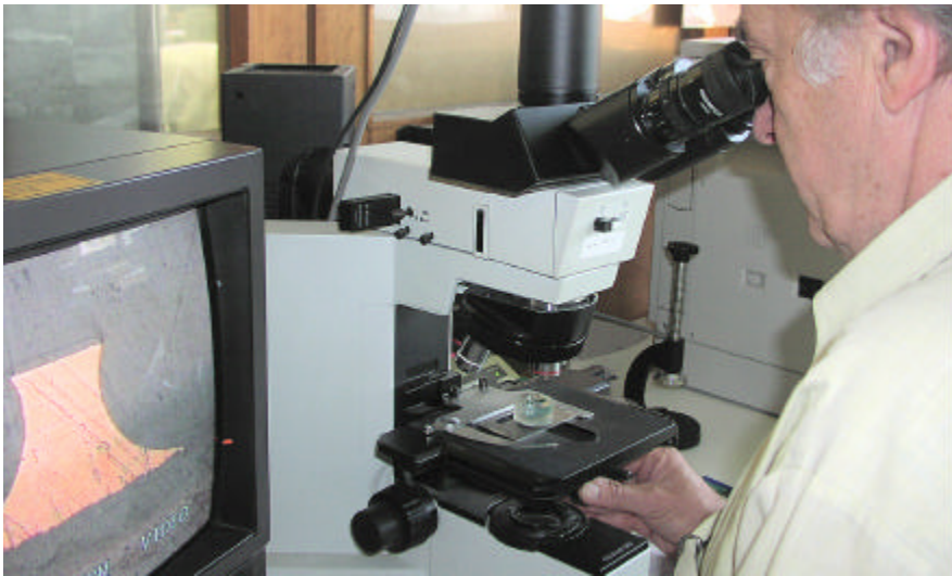
Mikroskopische Auswertung einer 400µ Leiterbahn in 100-facher Vergrößerung
