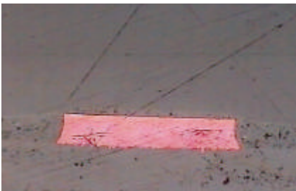
Zum Vergleich: 100µ dicke Leiterbahn
