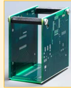
Verbindung zweier Leiterplatten durch 3D- Technologie, hier für ein ISO-Schienengehäuse.
