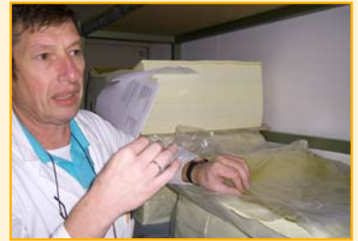
Die Glasfasermatten (Prepregs) lagern in einem eigens klimatisierten Raum und müssen binnen drei Monaten verarbeitet werden.
