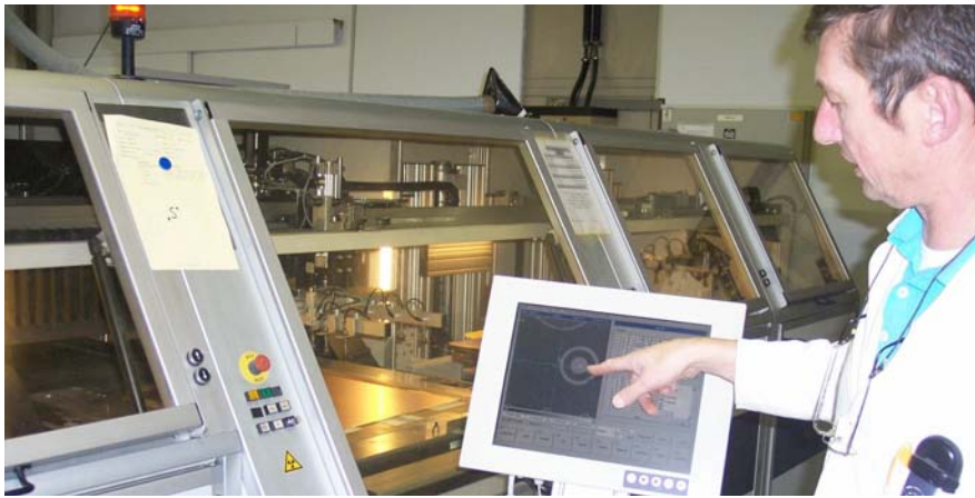
Überprüfen des Innenlebens von Multilayer mit Hilfe der Röntgenbohrmaschinen
