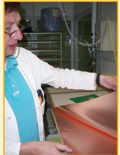
Kupferfolien von 9µ bis 210 µ können schwimmend verlegt werden.
