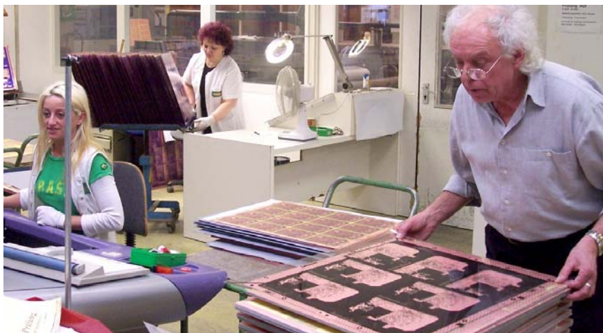
Nach Freigabe der Leiterplatten gehen die Platinen weiter in die Galvanik, zum Aufbringen des Lötstopplackes oder in die Innenlagenproduktion.
