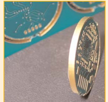
Leiterplatten mit Randkontaktierung Stegtechnik im Mehrfachnutzen.
