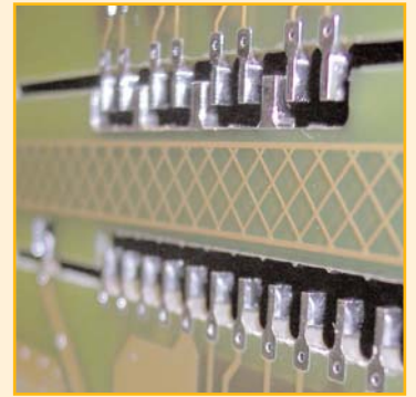
Leiterplatte mit umlaufend metallisierten Steckerzungen in HAL.
