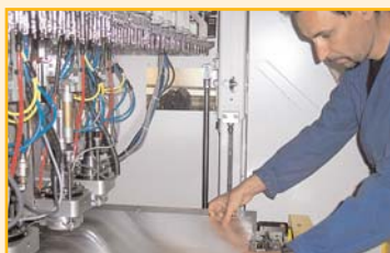
15.000 Bohrungen pro Stunde sind für die Posalux 6000 D kein Problem.
