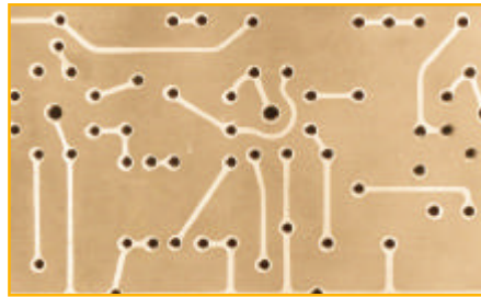
Eine Leiterplatte der ersten Stunde: Phenolharz gebundenes Hartpapier aus dem Jahre 1958
