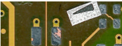
BILD 1: Fehlstellen durch Verunreinigungen aus nicht 100% ig geöffneten Vias und Benetzungsprobleme vor HAL
