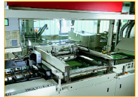
Viasfüller im Siebdruck-Verfahren
