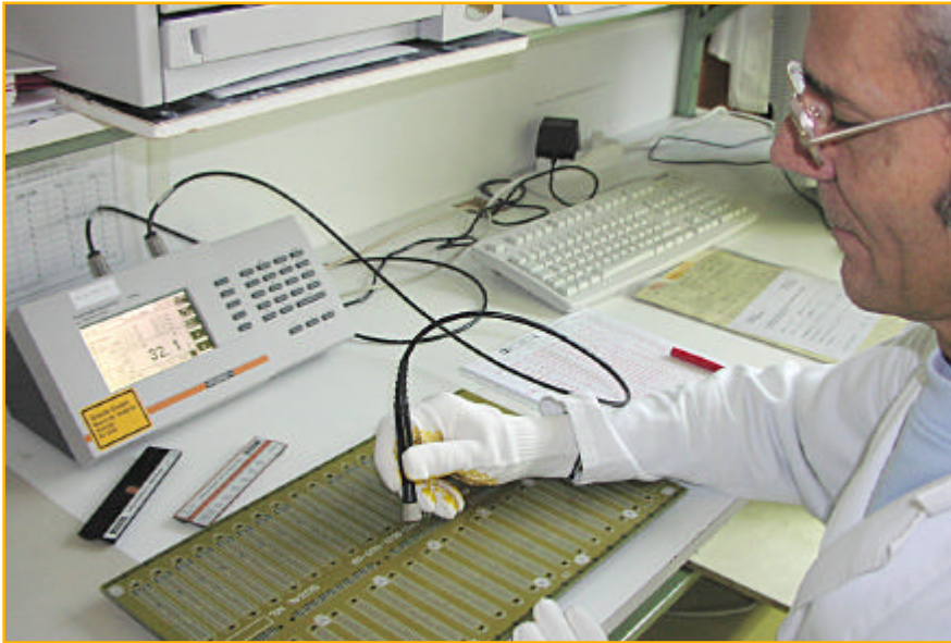
Prüfung der Kupferschicht: Mindestens 25 µm Kupfer benötigen Platinen für Einpresstechnik
