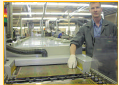
Durchlaufanlage für chem. Verzinnung
