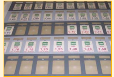
„Tool-Dispenser“: Bohrer auf Knopfdruck
