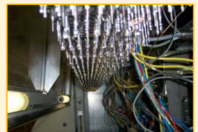
Bohrerstärken von 0,10 bis 6,60 mm: Fehlende Durchmesser gibt's nicht mehr.
