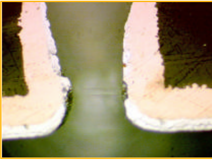
Unerwünscht: Randwulstbildung bei der Kupferabscheidung im Bohrloch.
