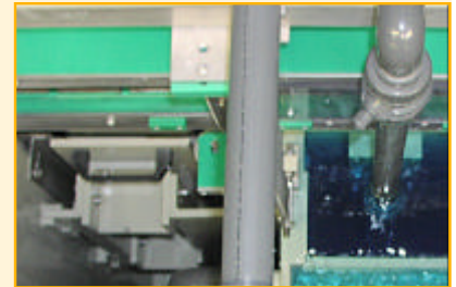
Vor der Verkupferung wird die Platte chemisch gereinigt.
