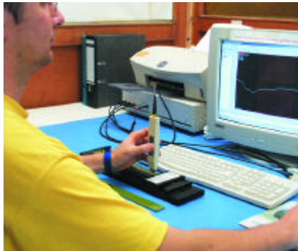
Industrieelektroniker Michael Kiencke am Greule-Arbeitsplatz für Impedanzmessung mit der Ausstattung der Firma Polar-Instruments.
