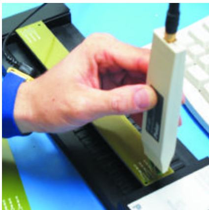
Einsatz des Messkopfes zur Impedanzmessung am Testcoupon
