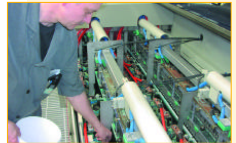
Manuelle Bestückung der Anoden mit Kupferkugeln
