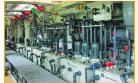
Rückseitige Ansicht des VCP-Platers mit Versorgungseinheiten
