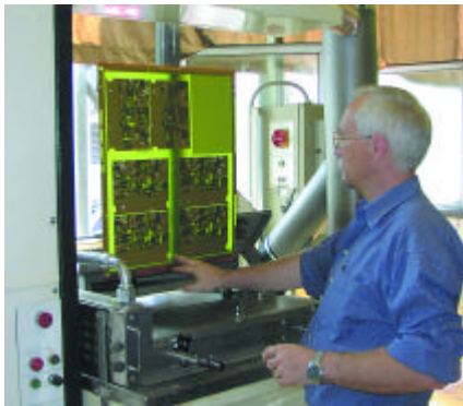
Versuchsanlage für Heissluftverzinnung in vertikaler Bauweise
