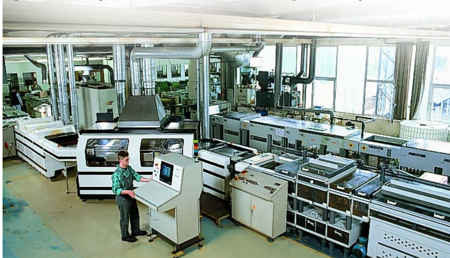
Auch die horizontale 45-Grad-Heißluftverzinnsanlage wird in Kürze auf Bleifrei umgestellt
