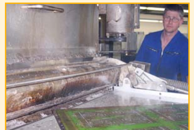
Heißluftverzinng an der 45°-Anlage
