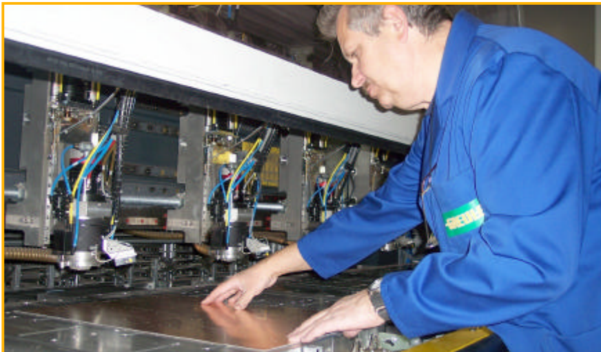
Hochmoderne Bohrmaschine: Die 5-Spindel-Maschine „Ultra Speed 6000“
