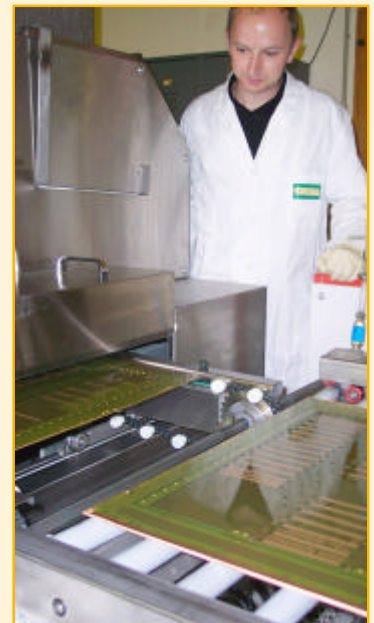
Mathias Kürbis bei der Sichtkontrolle des Sprühbildes zwischen dem Sprühen und dem Trocknungsöfen.
